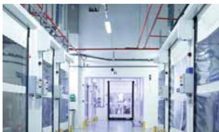
ARaymondlife est organisée en plusieurs ateliers dédiés par type de produit. L'injection, l'assemblage et le conditionnement primaire sont réalisés en salle blanche. Les zones d'atmosphère contrôlées, classées ISO 5 au repos, sont monitorées en continu.
